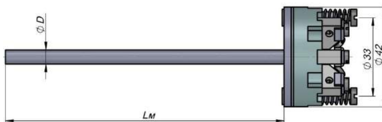
Датчики температуры с термометрической вставкой
