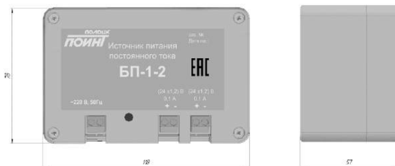
Рисунок 8.1 – Источник питания постоянного тока БП-1 в открытом исполнении
